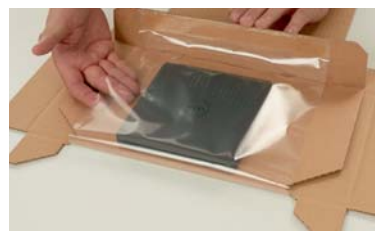
Packgut unter der Folie platzieren
